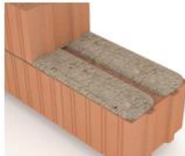
Montaje 2: Junta horizontal de mortero interrumpida por un hueco de 30 mm de espesor
